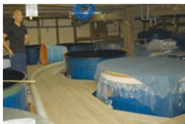
▲攪拌や搬入の負担を減らすため、金尾さんがタンクまわりに作った足場。
