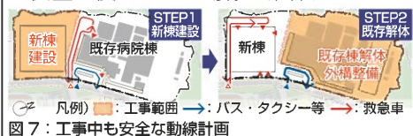
図 7：工事中も安全な動線計画
