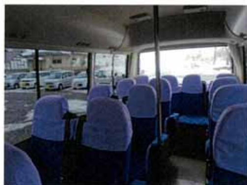
車内補助棒設置
